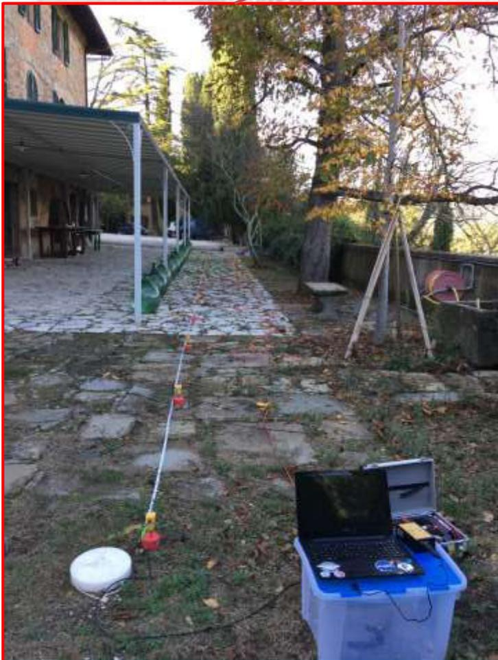
*foto 2. Visione dello stendimento di 24 metri durante l'esecuzione dell'indagine MASW.*
