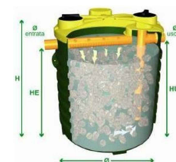
Filtro percolatore aerobico con pompa per il sollevamento del refluo in uscita
