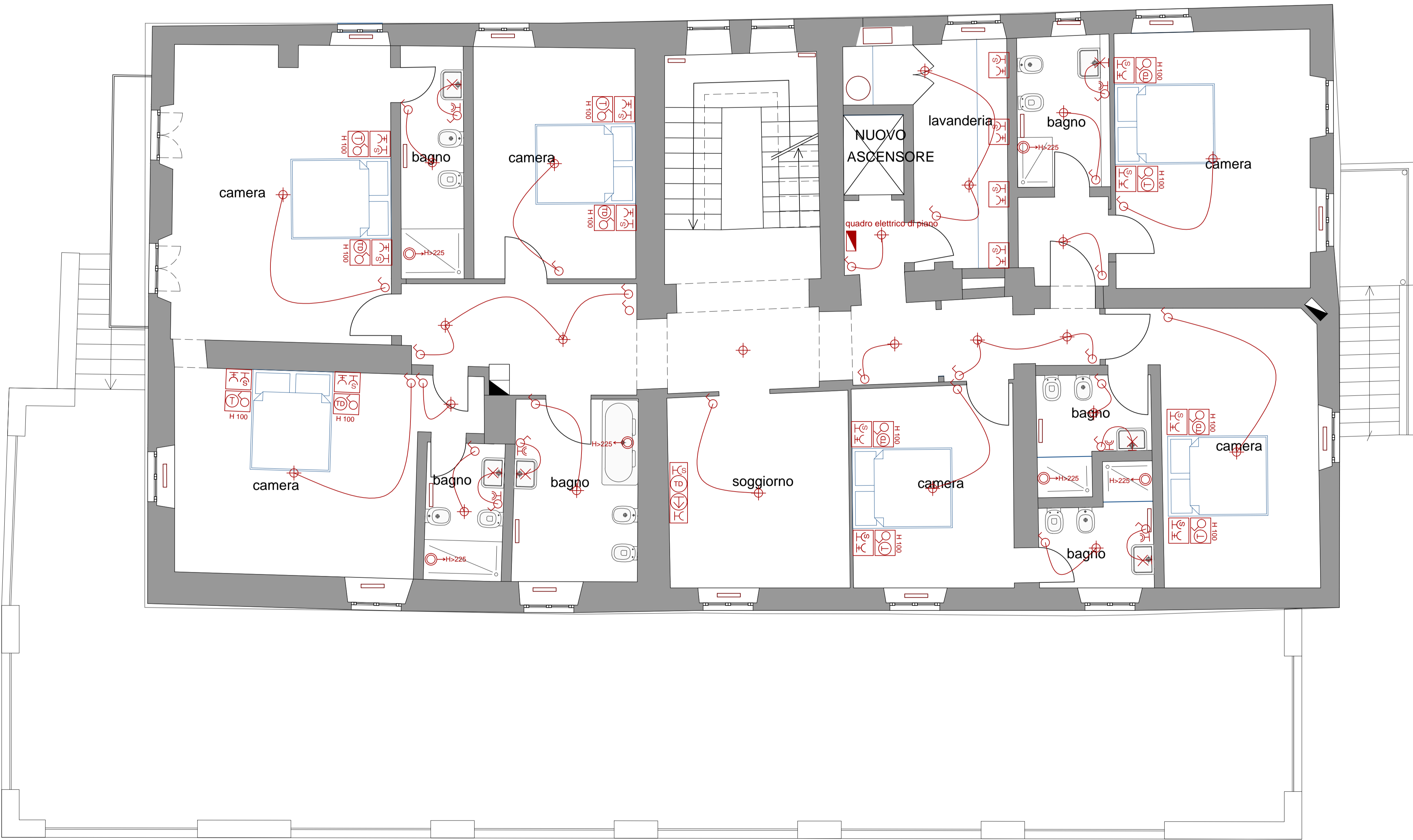
PIANTA PIANO PRIMO - IMPIANTO ELETTRICO SCALA 1:50
