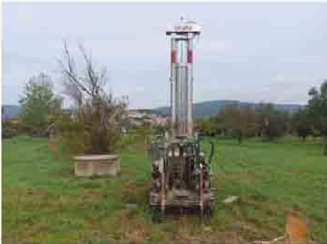
FOTO 1: Strumentazione utilizzata per l'esecuzione della prova CPT 2.
