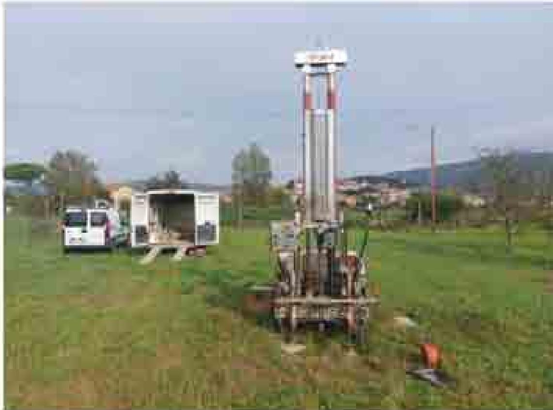
FOTO 1: Strumentazione utilizzata per l'esecuzione della prova CPT 1.
