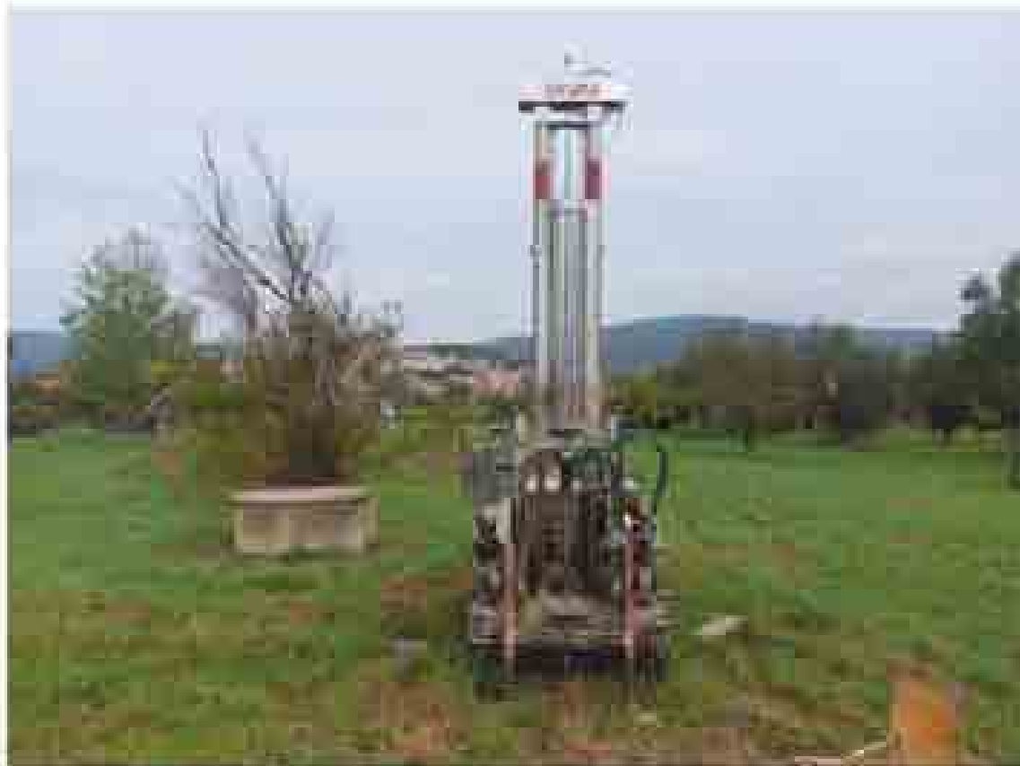
FOTO 1: Strumentazione utilizzata per l'esecuzione della prova CPT 2.
